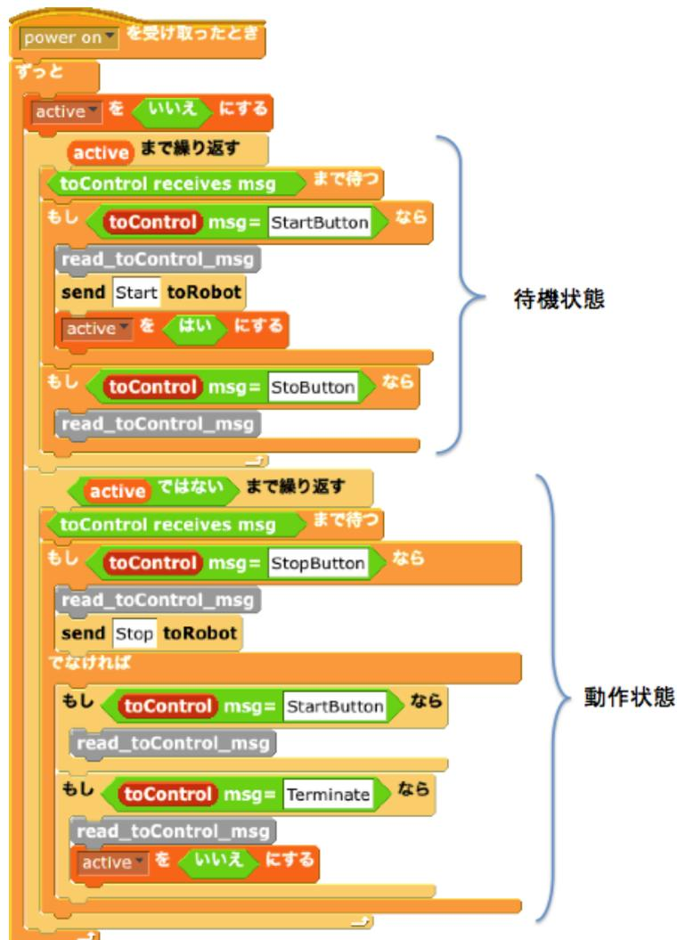
リモコンはメッセージを受信すると何らかの動作を行うようにしている。toControl receive msg ブロックはつぎのような述語型のブロックとして作成しているため、「toControl receive msg を待つ」は「toControl\_availabe を待つ」と同じことである。メッセージのやり取りを意識してこの
