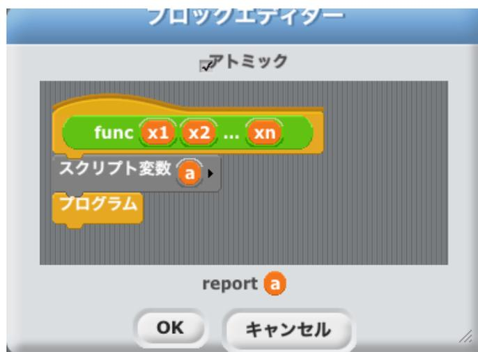
ブロックの作成は変数カテゴリー中にある「ブロックを作る」で行い、レポーター型のブロックとして作成する。ブロック名は自由である。また、ブロック内では仮引数用の変数として  $x_1, x_2, \dots, x_n$ , 出力変数として  $a$  を用い、 $a$  の値を report することにする。なお、スクリプト変数<sup>6</sup>は  $a$  以外にも自由に使えるものとする。
