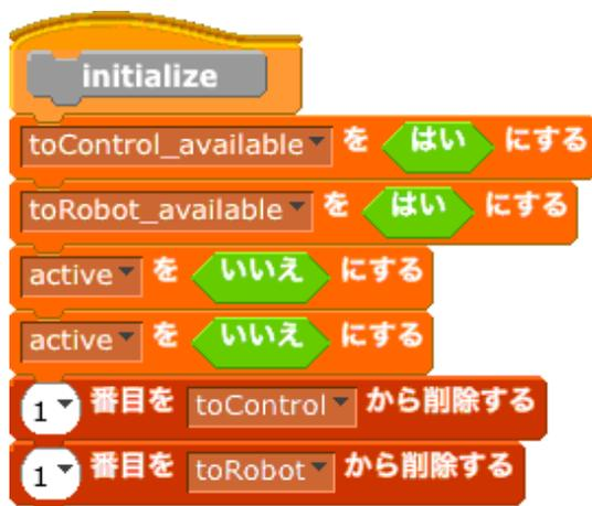
変数の toControl\_available と toRobot\_available はそれぞれリスト toControl, toRobot が使用できるかどうかを表すためのブール変数である。リストには高々1つのデータしか登録できないという仕様のために、ここが危険領域になる。そこでピーターソンのアルゴリズムと同様にこのような変数を用意して管理する。また、変数の active はリモコンからロボットに Start を送信したことを表すためのブール変数で、変数 action はロボットが動いていることを表すためのブール変数である。
