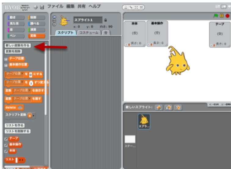
4. 本体の1番目の文字が本体の状態を表すことになるが、可読性をよくするためブロックを作成して「本体の状態」で使えるようにする。ブロックの作成は変数カテゴリ内の最後尾にあるボタン「ブロックを作る」をクリックする。レポート型を選び、「本体の状態」と名前を付ける。
