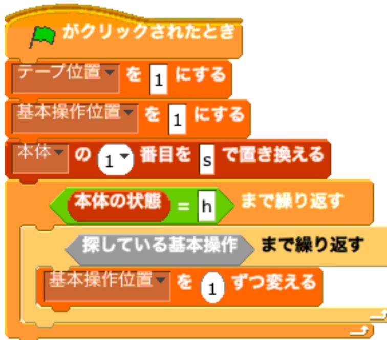
16. 探している基本操作なので、その後にかかれてある情報を読んでテープの書換、ヘッドの移動、状態の遷移を行う。テープ位置の文字を基本操作で指定される文字に書換し、テープのカーソル位置をヘッドの移動に応じて1増減し、最後に本体の状態を書き換えて基本操作の位置を先頭に戻す。なお、テープ位置が右端や先頭にある場合には、それぞれヘッドを右や左に動かす場合そこには空白文字があると考えるので、空白記号のbを挿入する。
